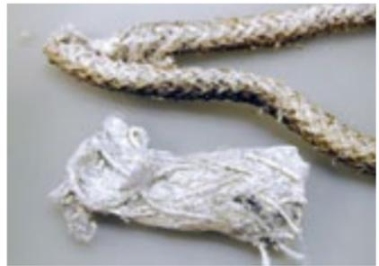
Dichtungsschnüre aus reinen Asbestfasern (Quelle: IST)
